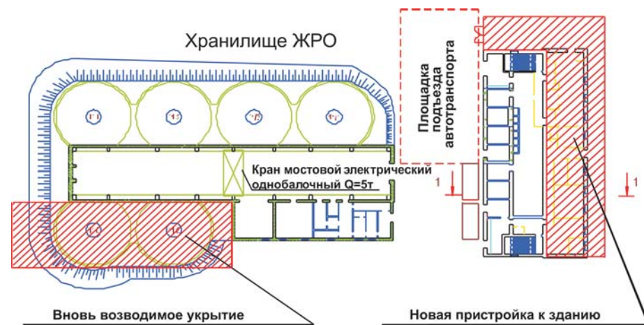
Рис.3. Схема расположения зданий и укрытий для размещения оборудования цеха ЖРО
