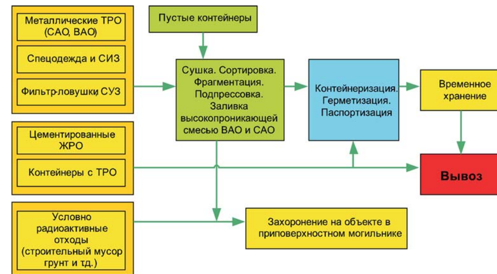
Рис. 5. Принципиальная схема обращения с ТРО
